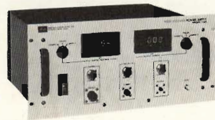
Alimentatore per provare i tubi dei TV color.
