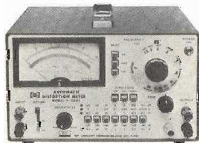
Misuratore di distorsione con range di misura da 0,1 a 100% del fondo scala.
