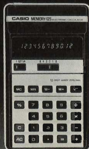
M 12S L. 33.000 + I.V.A. 14% 12 cifre verdi, memoria indipendente, percentuali, virgola fluttuante o posizionabile sino a 6 decimali, troncamento, arrotondamento 2° decimale, radice, alimentazione mista.
